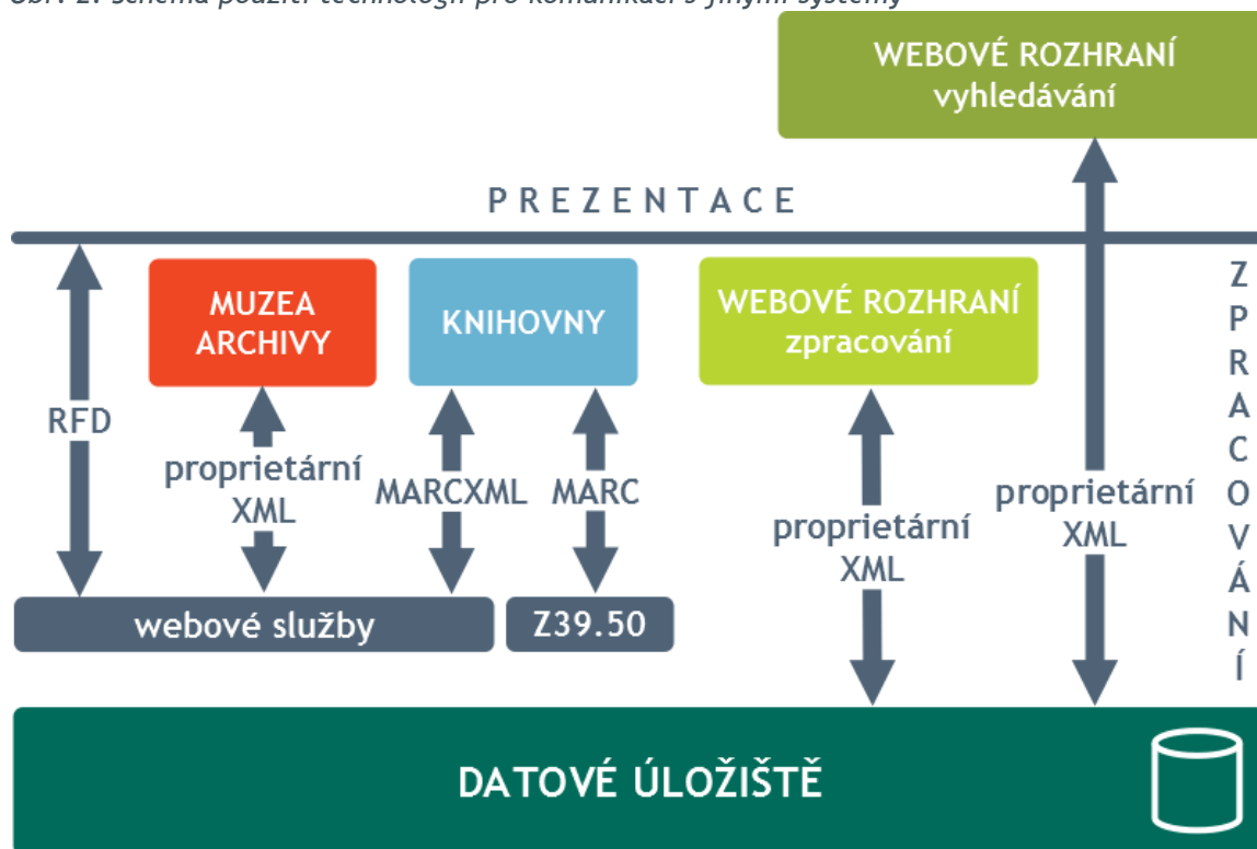
Obr. 2: Schéma použití technologií pro komunikaci s jinými systémy
